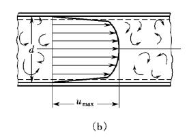
湍流: 流体质点强烈碰撞、分离与混合,使截面上靠中心部分各点速度接近,速度分布较均匀,只有在靠近管壁处流体质点的速度骤然下降。当Re越大,湍流程度越高时,中心部分的速度分布越均匀。
